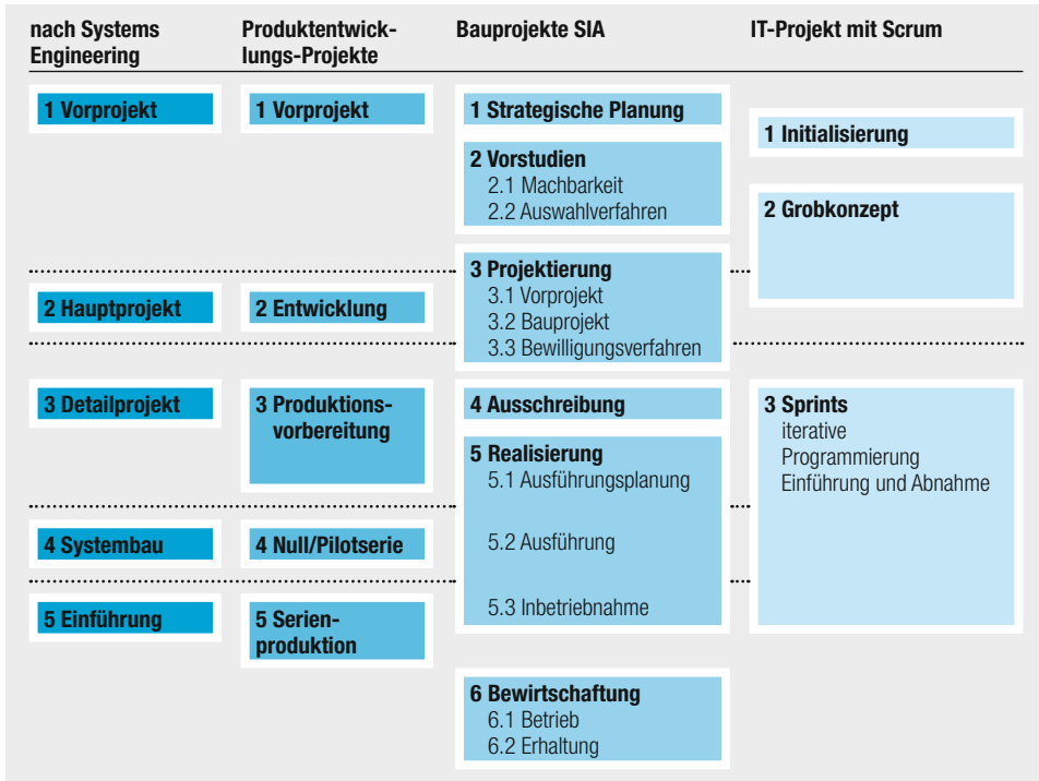
Abb. 1.10 Phasenmodelle und Phasenbezeichnungen
